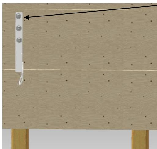
*Schraubenlänge **L** wird in Abhängigkeit vom vorhandenen Dachaufbau festgelegt.*
