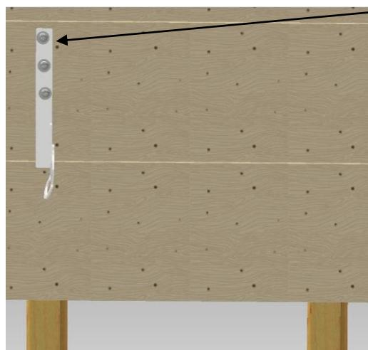
*La longueur des vis **L** est définie en fonction de la surélévation de comble existante.*
